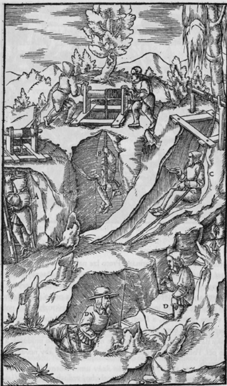
Po žebříku do šachet sestupující A. Na dřevěném valachu sedící B. Na kůži sedící C. Sestupující po schodech do skály vytesaných D.
